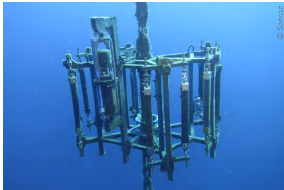
Dispositif avec coupons de polyéthylène haute densité (PEHD) et de polytéréphtalate d'éthylène (PET) pour le suivi de la biocolonisation des ancrages et câbles électriques et la quantification de l'hydrodynamisme
