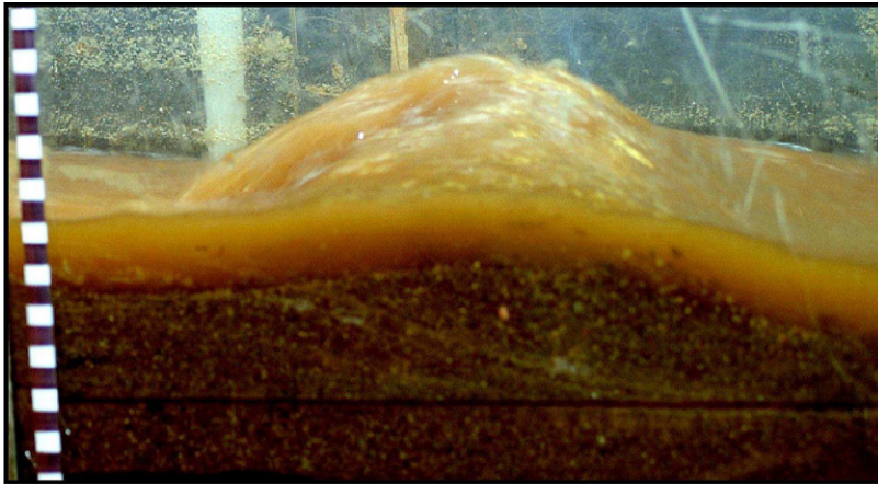
Fig. 41 : Capture vidéo d'une expérience en canal à courant montrant une onde stationnaire au-dessus d'une antidune (Carling et al. , 2008).
