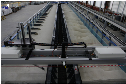
Fig. 46 : (a) Image du canal à courant (BAW, Karlsruhe, Germany) ; (b) Vitesses longitudinales du courant au-dessus de dunes calculées par le modèle (TELEMAC3D). Les cercles correspondent aux mesures ADV réalisées en canal (Goll et al. , 2012).
