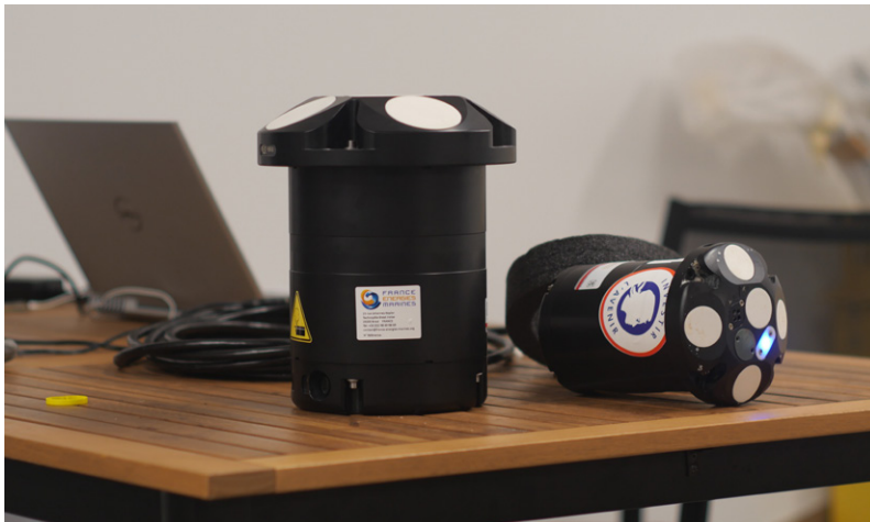
Fig. 33 : Exemple de profileurs de courant à effet Doppler.
