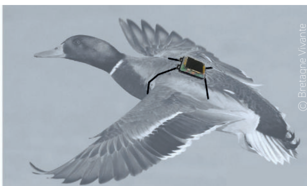
Fig 3. Schéma du montage en "backpack" sur un canard colvert d'une balise GEOBIRD au moyen d'un harnais en téflon.
