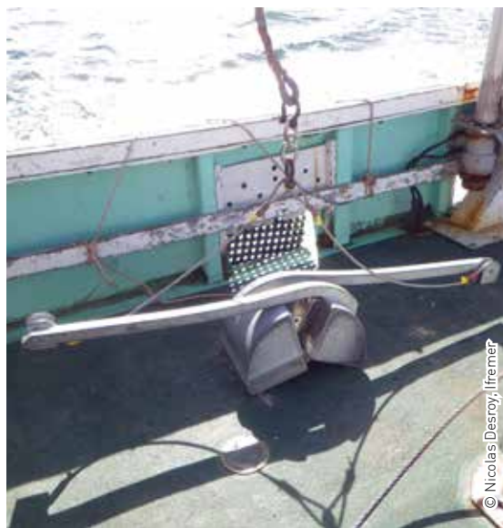
Fig. 23 : Benne Van-Veen ouverte sur le pont d'un navire.
