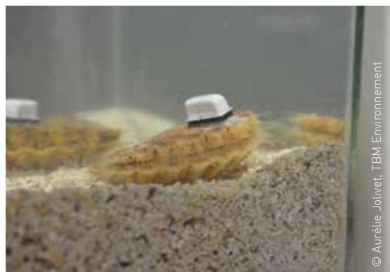
Fig. 43 : Fixation des accéléromètres sur les coquilles Saint-Jacques.
