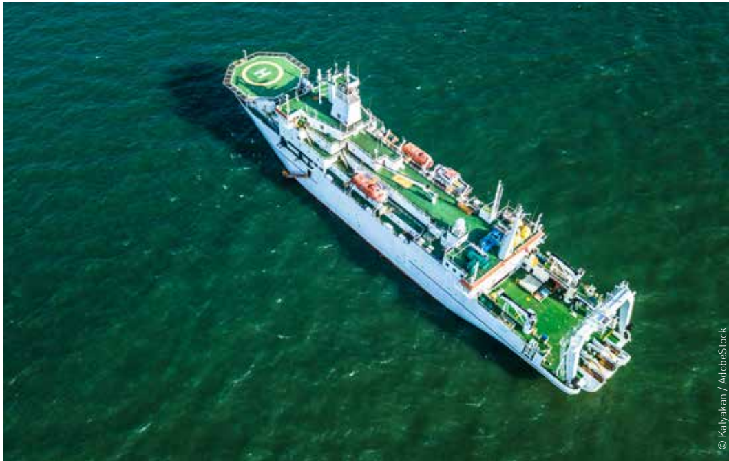
Fig. 57 : Navire utilisé pour installer les câbles électriques sous-marins.
