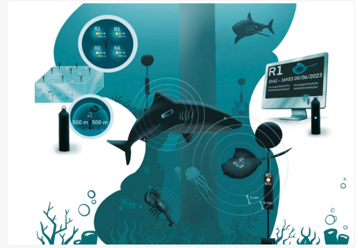
Fig. Illustration conceptuelle de la méthodologie de télémétrie acoustique passive. Des poissons et crustacés sont équipés de marques acoustiques individuelles émettant chacune un signal unique capté par un réseau de récepteurs.
