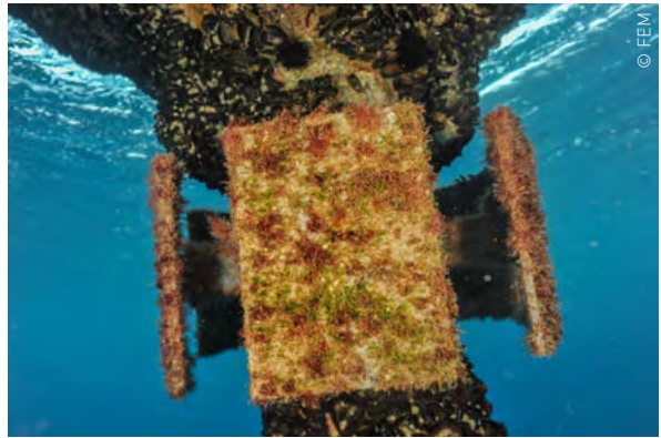
Dispositif avec des plaques de polychlorure de vinyle (PVC) pour un suivi de la biocolonisation sur plusieurs années
