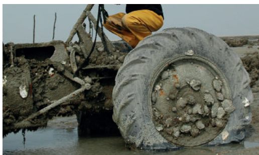
Fig 9. Installation d'hermines, de balanes et d'huîtres sur des supports parfois insolites, ici un tracteur abandonné depuis une vingtaine d'années en Baie du Mont Saint-Michel. Les composants métalliques sont totalement recouverts par des organismes alors que les pneus ne sont quasiment pas colonisés.
