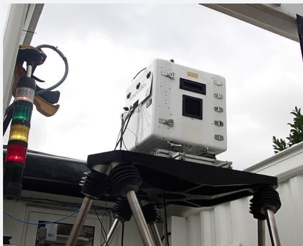
Première série d'essais avec un lidar profilant à 5 faisceaux monté sur un hexapode (© France Energies Marines)
